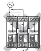
Запрещается выполнять перекрестные соединения между модулями и подключать к модулям другие устройства. При превышении номинального тока возможно повреждение разъемов для подключения к шине.
