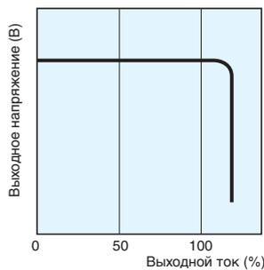
**Примечание.** Не допускайте состояния короткого замыкания или перегрузки по току в течение более 20 с - это может вызывать повреждение устройства.
