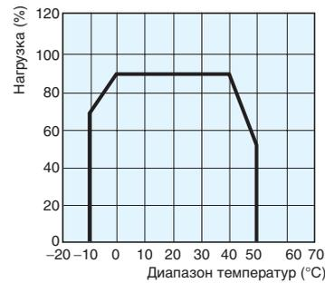
**Примечание.** При ухудшении характеристик применяйте принудительное воздушное охлаждение. Рабочая температура указана для точки на 50 мм ниже источника питания.
