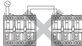
При соединении основных модулей между собой следует подключать вывод заземления только одного модуля.
