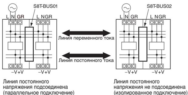
Линия постоянного напряжения подсоединена (параллельное подключение)
