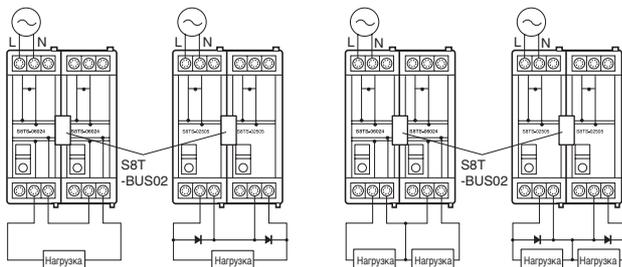
**Регулировка выходного напряжения при параллельном подключении**
