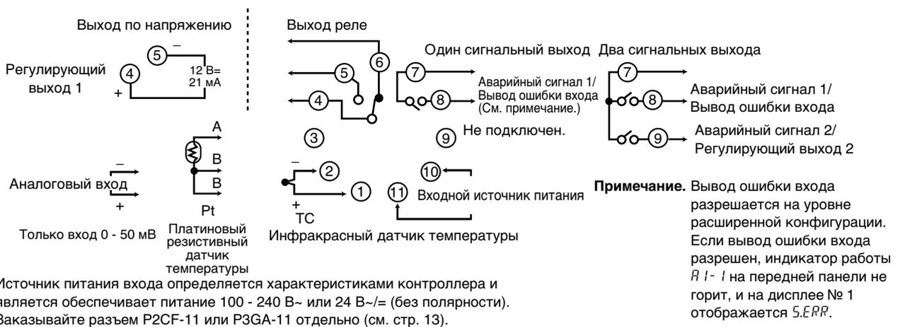
Источник питания входа определяется характеристиками контроллера и является обеспечивает питание 100 - 240 В~ или 24 В~/= (без полярности).
