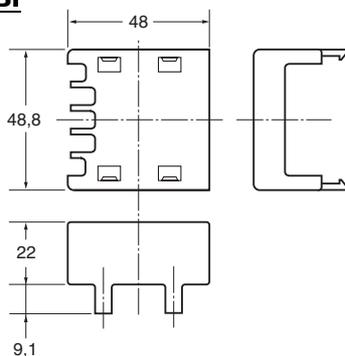
**Примечание.** Окончание "500" добавляется к номеру модели, если контроллер оснащен клеммной крышкой E53-COV10.
