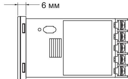
По сравнению с предыдущими моделями E5CN не претерпели изменений: размеры монтажного выреза, размеры внутренней панели для монтажа на панель, размеры винтов клемм, расположение соединительных клемм и способы настройки параметров.
