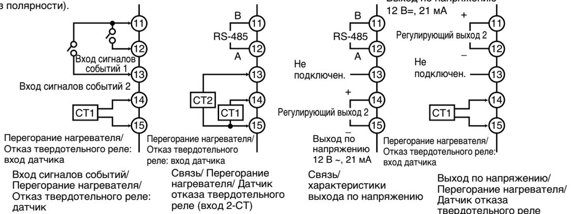
Клеммы 11 - 15 отсутствуют в моделях без дополнительного блока (датчик перегорания нагревателя, регулирующий выход 2, входные сигналы событий или связь). Использование клемм зависит от модели дополнительного блока.
