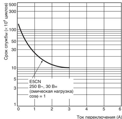
**Примечание.** Не подключайте нагрузку постоянного тока к контроллеру с выходом долговечного реле.
