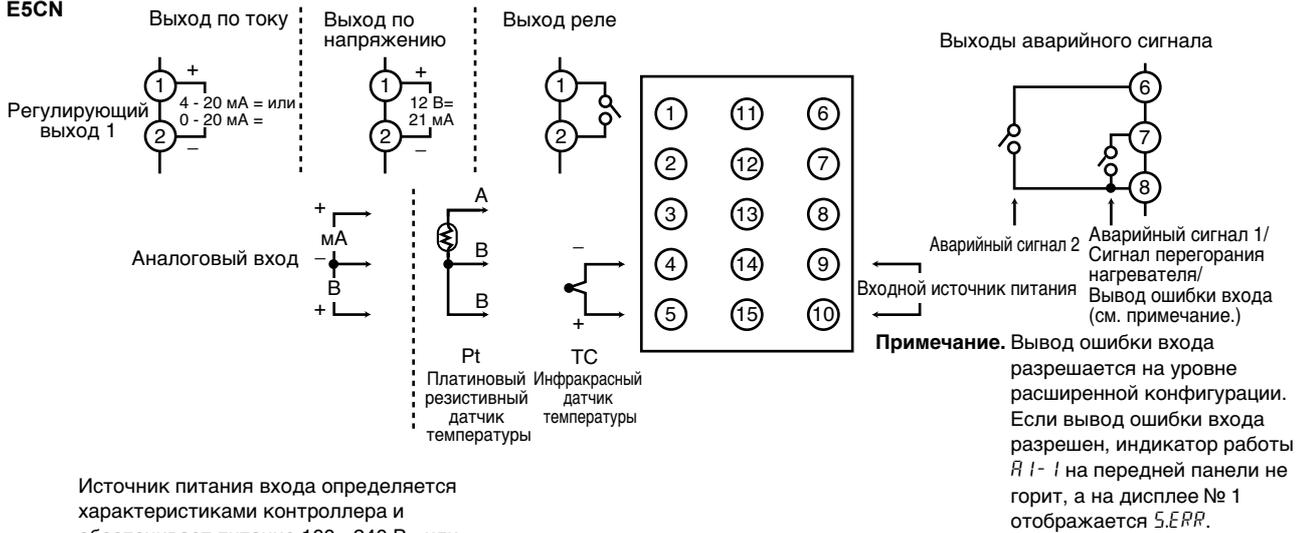
Источник питания входа определяется характеристиками контроллера и обеспечивает питание 100 - 240 В~ или 24 В~/= (без полярности).
