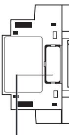
Крышка гнезда для подключения модуля расширения
