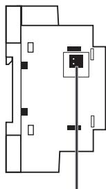
Гнездо для подключения батареичного модуля (для подключения батареичного модуля удалите заглушку)
