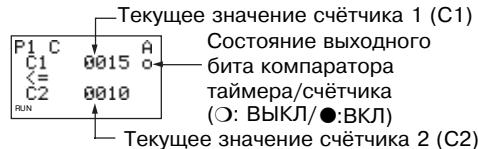
**Примечание** 1. С помощью кнопки **ALT** можно установить в качестве сравниваемого сигнала 2 счётчик/таймер (их адрес) или константу.
