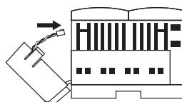
2. Подключите шнур батареичного модуля в гнездо модуля CPU.
