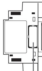
Крышка разъема для подключения модуля расширения
