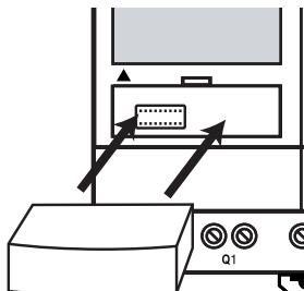
**Примечание** Прежде чем снять или установить модуль памяти, необходимо отключать питание модуля CPU.
