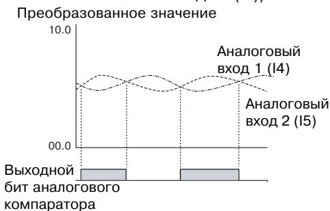
Выходной бит аналогового компаратора включается, когда напряжение на аналоговом входе 2 выше напряжения на аналоговом входе 1.
