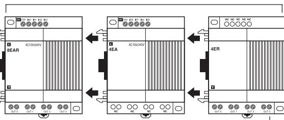
Реле способны переключать токи до 8А при напряжении 250В AC. Контакты всех четырех выходов взаимоизолированы.
