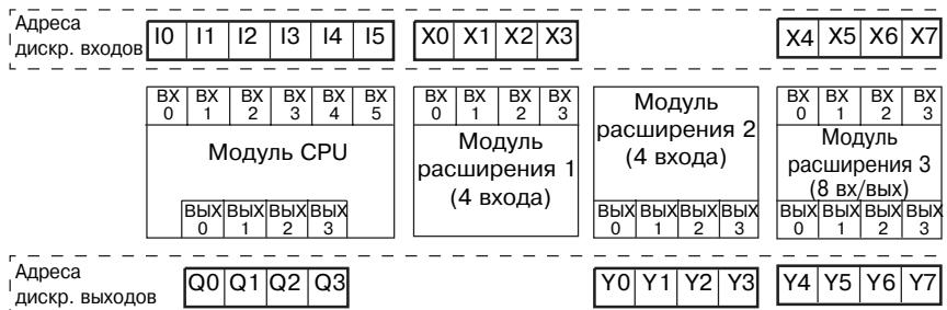
**Примечание** При подключении модуля расширения Вх/Вых, который имеет только входы или только выходы, например, модуля на 4 входа и модуля на 4 выхода на рисунке выше, неиспользованные адреса переходят на следующий модуль и используются для его входов/выходов.
