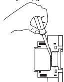
Вставьте плоскую отвёртку или аналогичный инструмент и удалите крышку.
